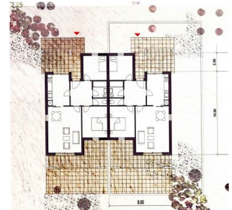
Vue en plan du logement de Type C
