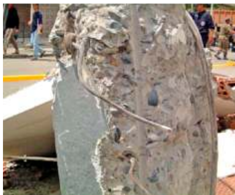
Fig 1-5 Empreintes du glissement des aciers à cause du gravier roulé
