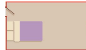
Mauvaise position du lit qui interdit de voir une personne entrante avant qu'elle ne soit à l'intérieur.
